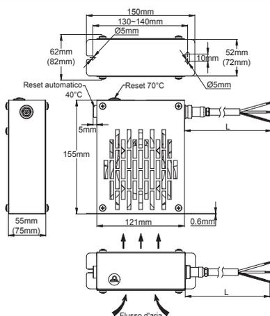
**Modello 9PF1:** Per il controllo remoto tramite termostato o umidostato, è dotato solo di un limitatore di temperatura a impostazione fissa e reset manuale.
