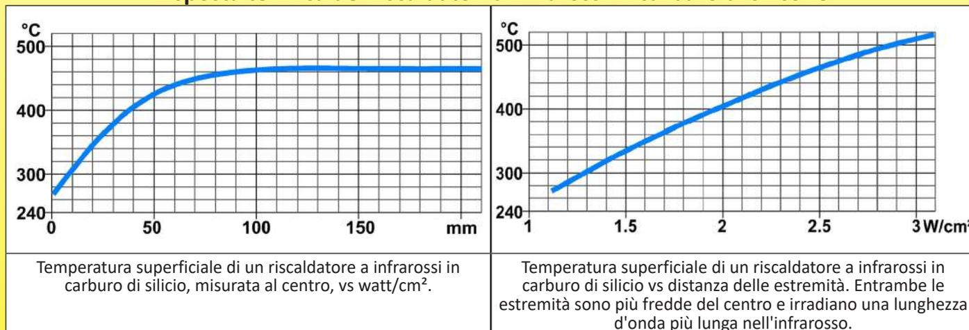
Temperatura superficiale di un riscaldatore a infrarossi in carburo di silicio, misurata al centro, vs watt/cm<sup>2</sup>.
